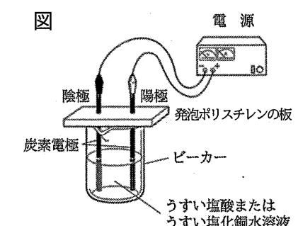
【実験2】ビーカーの中に、溶液としてうすい塩化銅水溶液を入れて電気分解を行った。
